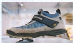
密着感を高めるためにペダルに固定される専用の靴。横にスナップをかけると外れる仕組み。
